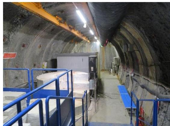
正面の壁の向こうに模擬のオーバーパックと緩衝材が埋設されている。手前はセンサー機
